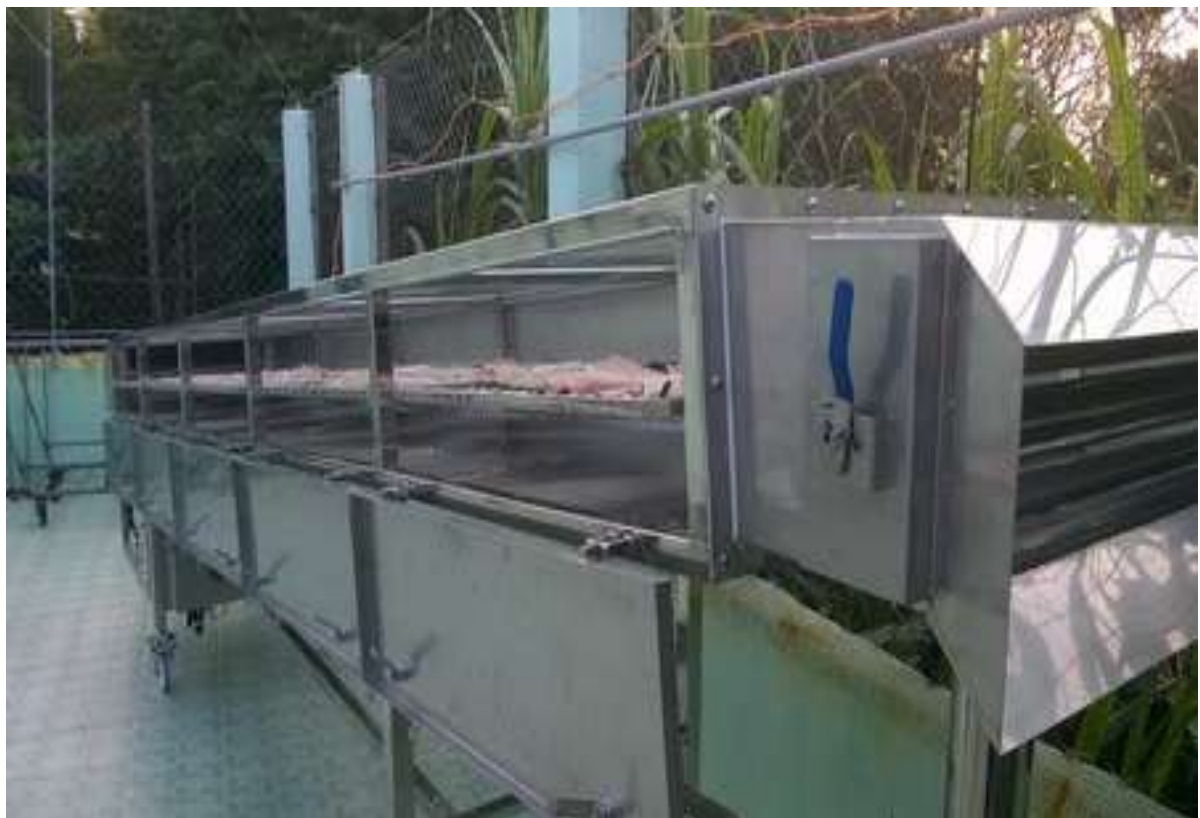
Hình 5. Máy sấy cá dạng phơi cá dùng năng lượng mặt trời
