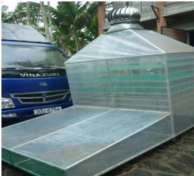
Hình 6. Buồng sấy ứng dụng năng lượng mặt trời dùng sấy nông sản
