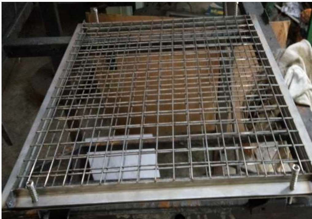
Hình 17. Vỉ phơi cá kích thước 450x450mm dùng lưới inox
