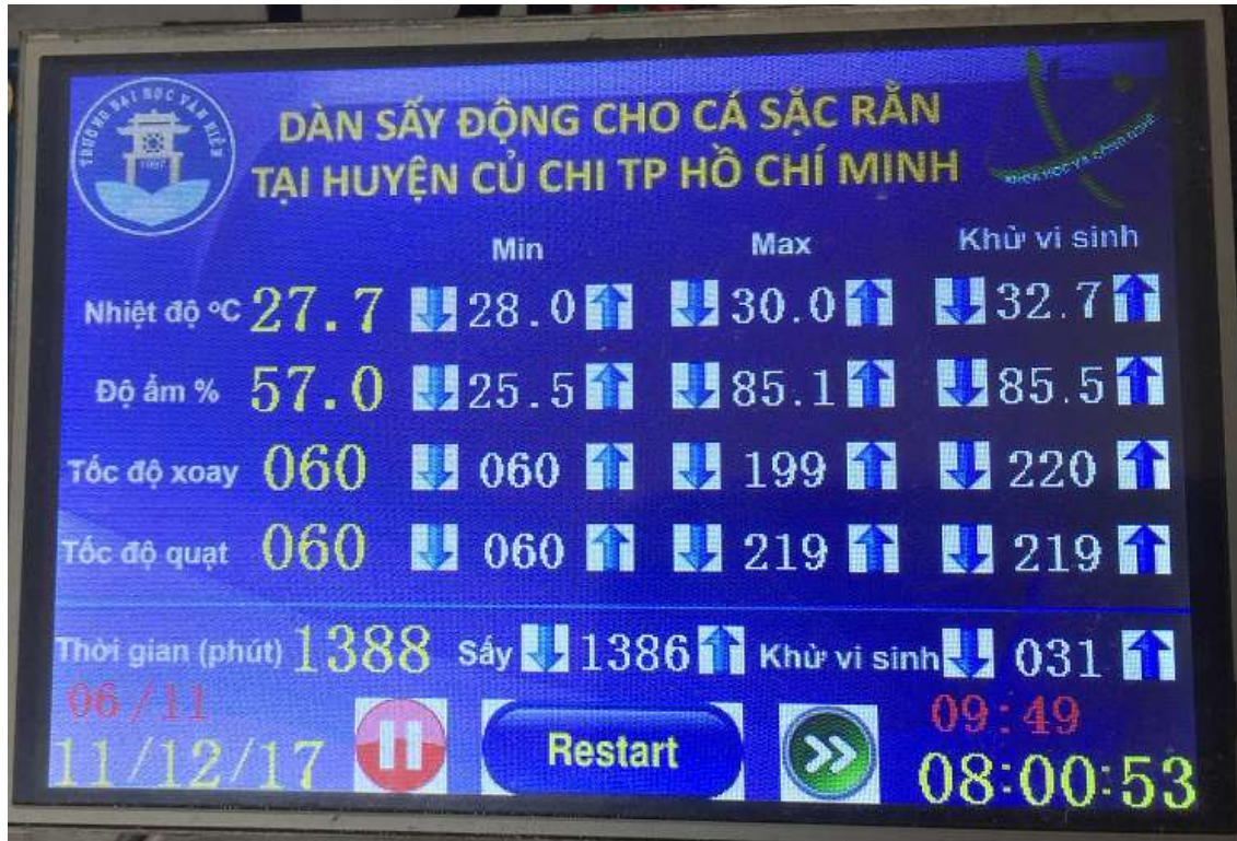
Hình 20. Giao diện điều khiển và giám sát trên LCD
