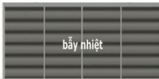
Hình 1. Thiết kế bẫy nhiệt mặt trời với lượn sóng dọc theo chiều hồi lưu của luồng không khí trong buồng sấy
