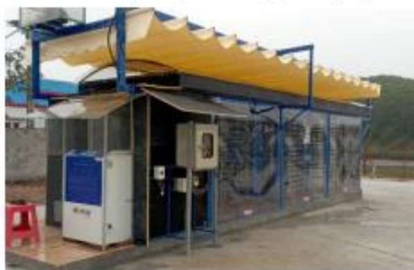
Hình 3. Mái che bạt giúp kiểm soát nhiệt độ buồng sấy
