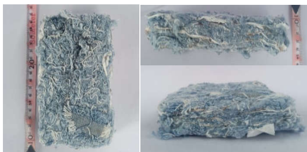
Hình 3. Sản phẩm vật liệu cách nhiệt với chất keo sinh học được giới thiệu bởi nhóm tác giả tại cuộc thi Hult Prize 2020 NTTU
